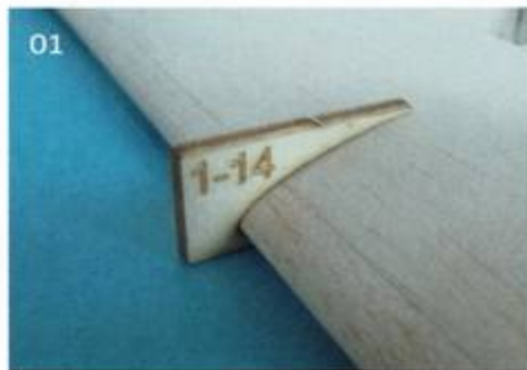
01 | Die Nasenleiste lässt sich dank der Schablonen gut verschleifen 02 | Der Start am Gummistart ist problemlos und ganz einfach auch alleine durchführbar 03 | Mit ein wenig Übung gelingt auch das Fangen zur Landung – wenn gleich das natürlich nicht regelkonform ist
